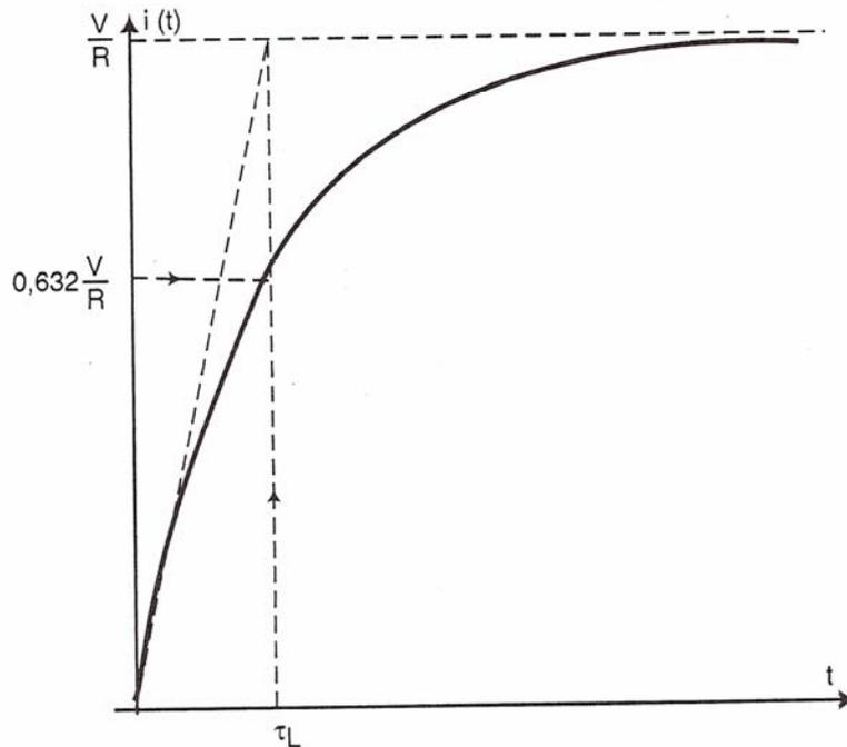
La bobina actúa como un amortiguador de  $i$  y permite que la Ley de Ohm se vaya cumpliendo progresivamente.
