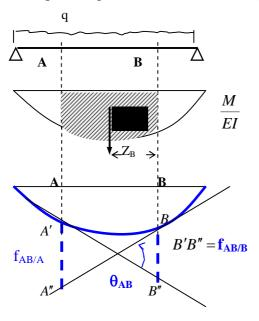
**Teorema I**: el ángulo comprendido " $\theta$ " entre las tangentes a dos puntos cualesquiera A' y B' de la línea elástica, es igual al área del diagrama de momentos reducidos entre las secciones A y B, correspondientes.
