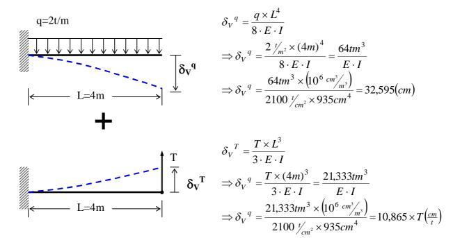
Resultando la deformación en la viga:
