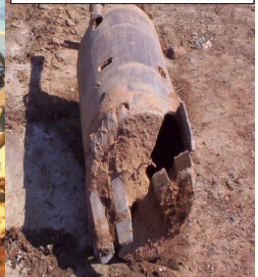
Brocal empleado en la excavación
