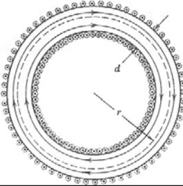
Aplicamos la Ley de Amper a una trayectoria circular de integración de radio  $r$
