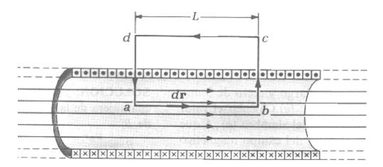
En el interior del solenoide ideal el campo magnético es uniforme y paralelo a su eje y el campo en el exterior del solenoide es cero.
