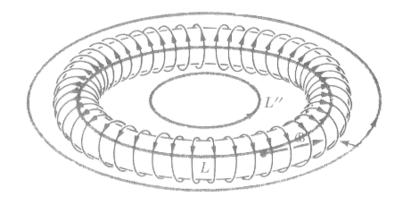
Vamos a calcular  $\,B\,$  en los puntos interiores, por simetría las líneas de  $\,B\,$  forman círculos concéntricos dentro del toroide, como vemos en el esquema siguiente
