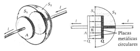
Por conservación de la carga, la rapidez con que se acumula carga en la placa del condensador
