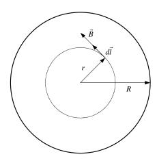
En la figura vemos una trayectoria circular dentro del alambre, al ser la corriente  $\dot{l}_0$ uniforme, podemos calcular la corriente  $\dot{l}$  que es la que se encuentra dentro del radio r
