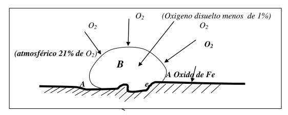
Sobre la plancha de Fe hay menos oxígeno disuelto que en B en la gota de agua. El potencial del hierro será mayor en A y se oxidará según:
